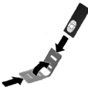
Рисунок 2 – Схема установки SIM-карты в разъём
